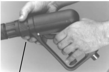
Le pistolet-pulvérisateur est équipé d'un régulateur de pression du jet. Pour diminuer la pression du jet, faire tourner l'anneau rouge (Pos. 3) de la poignée vers la droite, pour en augmenter la pression, faire tourner l'anneau vers la gauche. Le manomètre indique cependant la pression réglée préalablement au régulateur.
