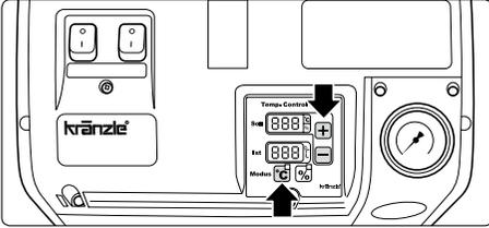
2. a) Mode Température: Sélectionner la température souhaitée au thermostat (min. 40 °C)
