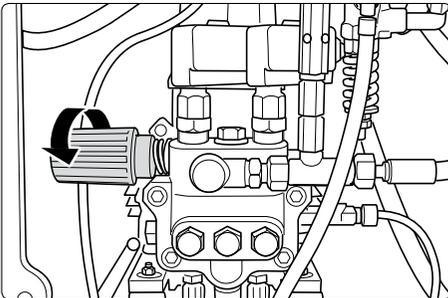
Le régulateur de pression à la tête de pompe permet de régler la pression de service ainsi que le débit d'eau et donc aussi de régler la température de l'eau en fonction de ces réglages.
