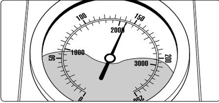
■ Après la fermeture du pistolet, le manomètre continue à indiquer pleine pression. Le nettoyeur se met en marche et s'arrête sans cesse.
