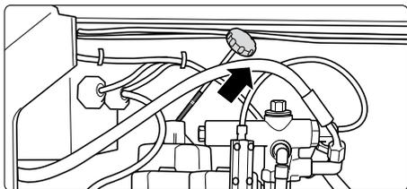
Ne pas mettre l'appareil en marche si le niveau d'huile ne se situe pas entre les deux repères de la jauge.
