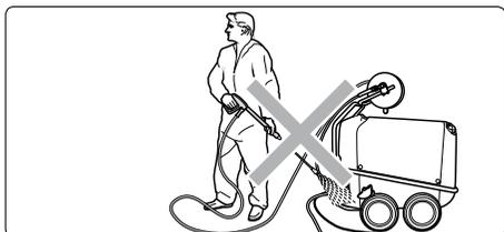
... nettoyer l'appareil avec le jet haute pression ou diriger le brouillard du jet de pulvérisation sur l'appareil;
