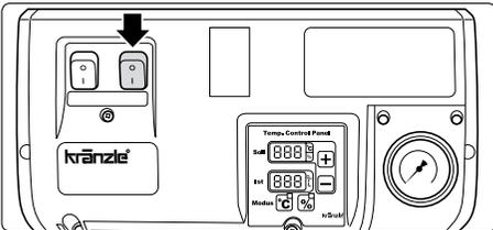
4. Mettre le chauffage en marche. L'eau se réchauffe, puis est maintenue en permanence à la température sélectionnée.
