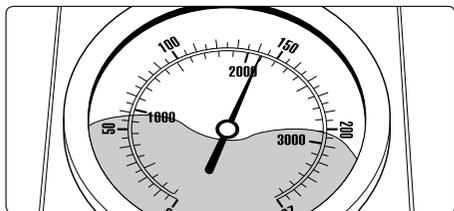
■ **L'eau ne sort pas alors que le manomètre indique pleine pression: La buse est très probablement obturée.** (Le liquide visible dans le manomètre n'est pas de l'eau, mais du glykol permettant d'amortir les vibrations de l'aiguille).
