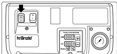
3. Enclencher l'interrupteur de service, le pistolet étant ouvert. Dépressuriser l'appareil: Ouvrir et fermer le pistolet à plusieurs reprises.
