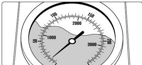
■ **Le manomètre n'indique qu'une faible pression et l'eau sort de la buse par à-coups; le tuyau haute pression vibre.**
