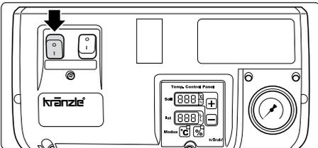
3. Enclencher l'interrupteur de service, le pistolet étant ouvert. Dépressuriser l'appareil: Ouvrir et fermer le pistolet à plusieurs reprises.
