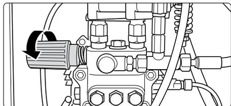
4. Réguler la pression de service en actionnant le régulateur de pression situé sur la tête de pompe: Le tourner vers la gauche pour réduire la pression de service et vers la droite pour l'augmenter..
