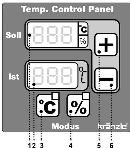
Le thermostat régule la température du jet d'eau.
