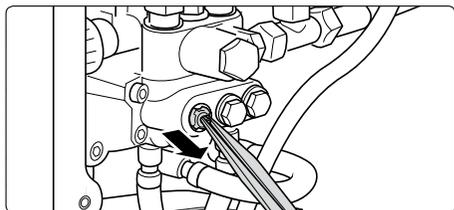
Nettoyez les soupapes avec un fil métallique (trombone) en les passant sous l'eau d'un robinet. Nettoyez aussi les sièges de soupapes dans la pompe.
